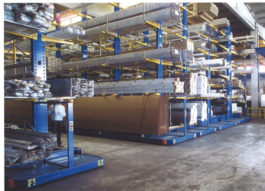
ICAM annovera realizzazioni di impianti con basi mobili sino a 70 m di lunghezza e 1.000 t di carico per base mobile.
