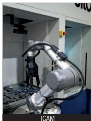
elevate: queste le caratteristiche distintive delle isole robotizzate di pick&place realizzate tramite l'integrazione di robot collaborativi, detti cobot, ai magazzini automatici verticali a vassoi traslanti Silo. La possibilità di configurare un magazzino verticale multi-colonna Silo con più baie di lavoro affiancate consente ai cobot di lavorare a fianco degli operatori, liberandoli da attività ripetitive, a volte faticose, e a basso valore aggiunto senza rischi per la sicurezza e con un
