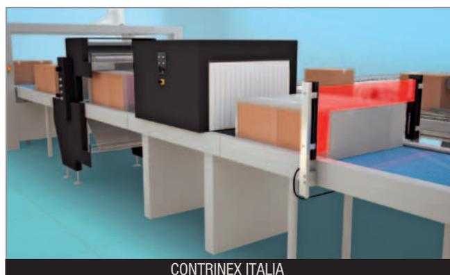
soluzione plug-and-play. Con una sezione di soli 40 x 20,5 mm questi dispositivi salva-spazio sono facilmente integrabili in sistemi diversi. I modelli DGI offrono altezze di rilevamento fino a 2.010 mm e sono in grado di rilevare oggetti con diametri di 0,9,
