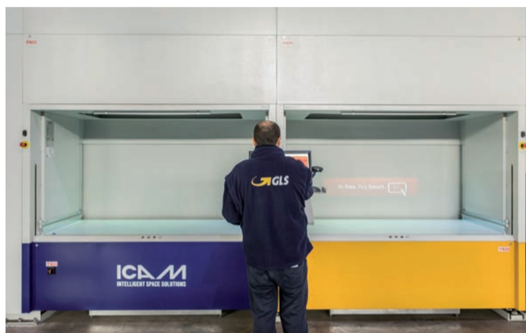
La presenza delle due baie di lavoro affiancate ha incrementato notevolmente il numero delle operazioni orarie: mentre l'operatore effettua il prelievo o deposito presso una baia di lavoro, il sistema procede con la successiva missione nella seconda baia, riducendo o azzerando il tempo di attesa.
