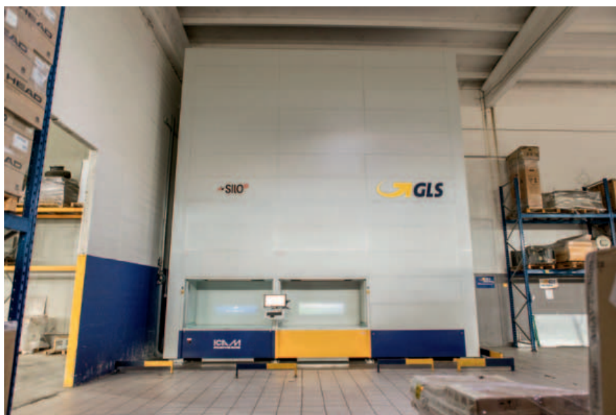
Silo 2 , magazzino automatico verticale multi-colonna su misura.
