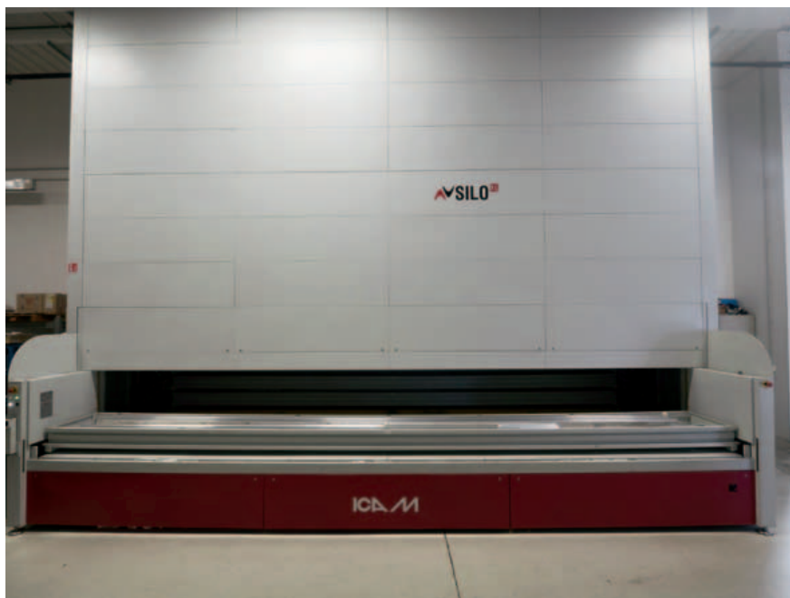
SiloXL, magazzino automatico verticale mono-colonna per corpi lunghi e/o pesanti.
